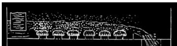
Figura 2 – Prato ou bandeja utilizada no interior da torre de destilação
