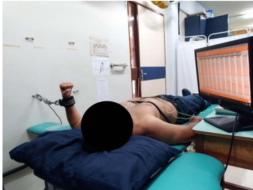
Figura 2 – Utilização da célula de carga e feedback para o paciente
