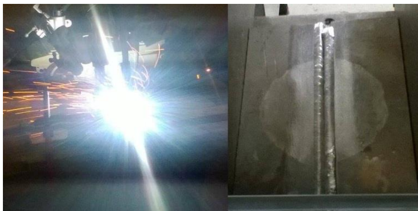
Figura 14- Processo de soldagem e a junta soldada.
