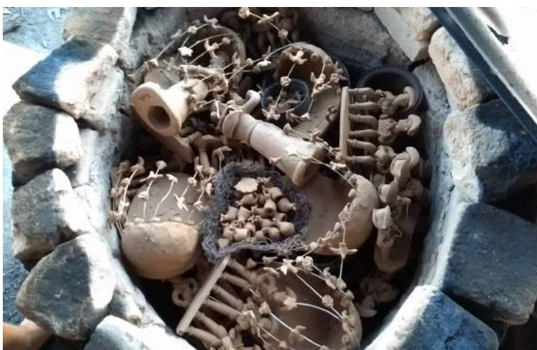
Figura 105: Organização das peças no forno para a queima das produções da família Zé Caboclo. Fonte: a autora.
