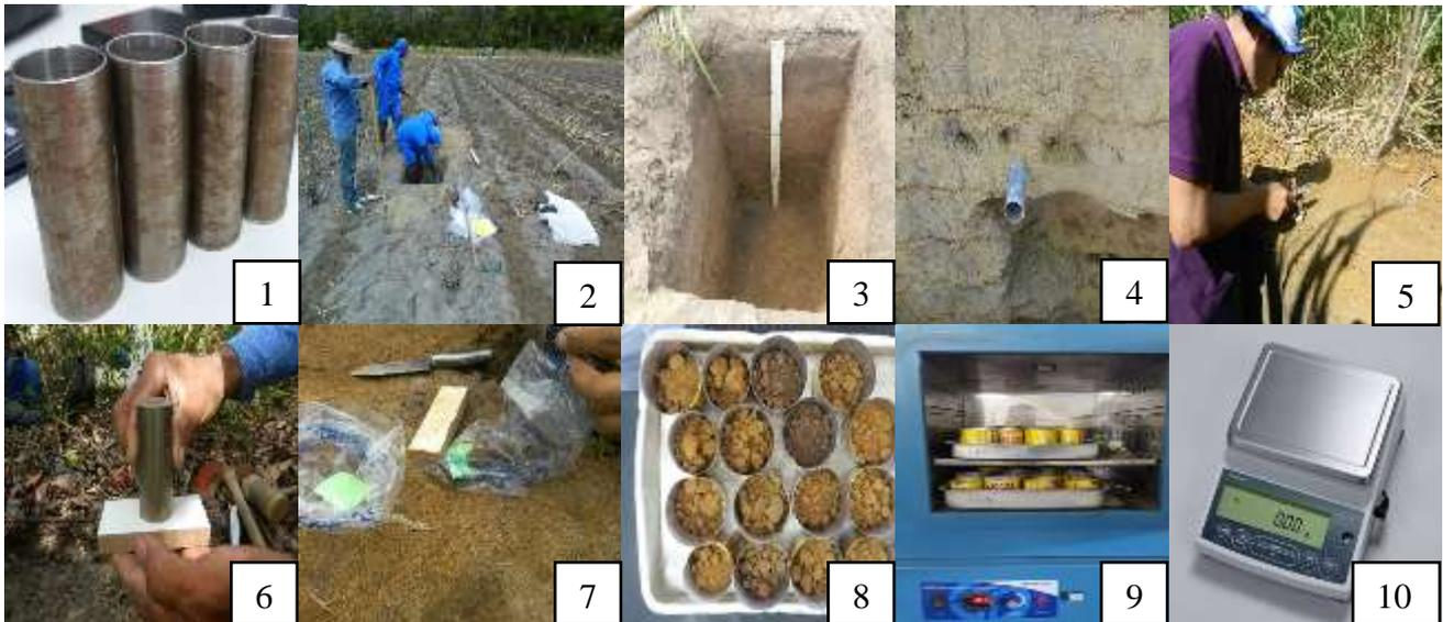
1. Cilindro utilizado para coleta; 2. áreas selecionadas; 3. trincheiras abertas; 4. coletas; 5 e 6. preenchimento do cilindro com amostra de solo nas camadas; 7. armazenamento e identificação das amostras; 8. acondicionamento em latinhas para pesagem com pré-pesagem; 9. secagem em estufa com circulação de ar até peso constante e 10. pesagem das amostras.
