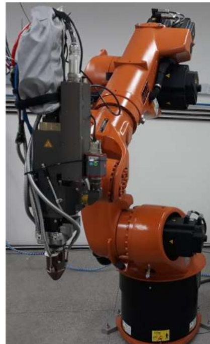
Figura 24 - (a): Sistema de alimentação de pó (powder feeder); (b): Cabeçote e sistema de movimentação.
