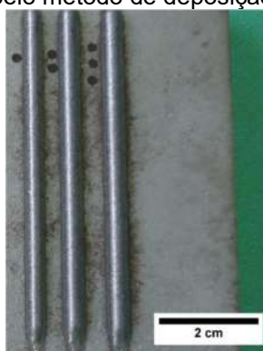
Figura 49 - Deposições produzidas pelo método de deposição coaxial do aço inoxidável AISI 316L
