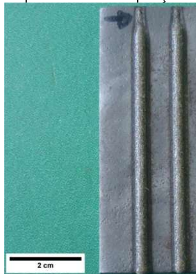
Figura 41 – Deposições produzidas pelo método de deposição coaxial do aço inoxidável AISI 431
