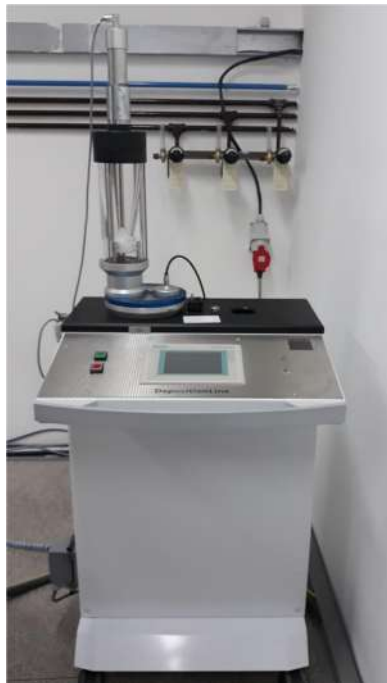
Figura 24 - (a): Sistema de alimentação de pó (powder feeder); (b): Cabeçote e sistema de movimentação.
