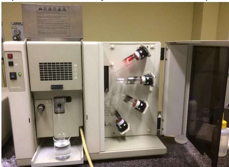
Figura 15 – Espectrômetro de Absorção Atômica com Chama (CRCN-NE/CNEN)
