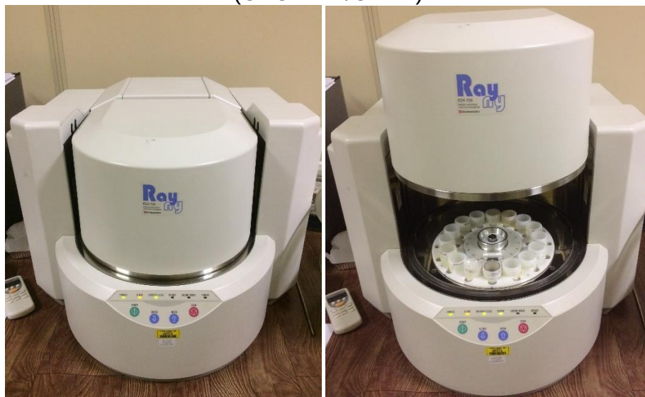
Figura 8 – Espectrômetro de Fluorescência de Raios-x por Dispersão de Energia (CRCN-NE/CNEN)
