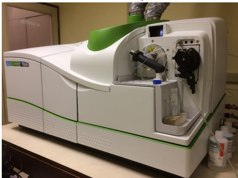
Figura 10 – Espectrômetro de massas com fonte de plasma induzido (CRCN-NE/CNEN)
