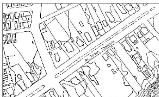
Figura 153 – Padrão construtivo seguindo o Código de Posturas de 1911, com recuos laterais para permitir a circulação do ar e a entrada de luz natural. O recorte traz as construções ao longo da Avenida Tomás Espíndola (início da Av. Fernandes Lima) no Farol.
