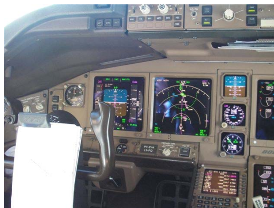
Fig.54- Uma nova apresentação informacional nos postos de trabalho do piloto -O Boeing 777 (Foto cedida pelo piloto Alexandre Rizzo, 2005)
