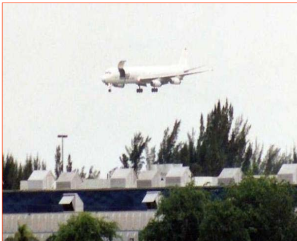
Fig.67a e 67b-Abertura não planejada de compartimentos das aeronaves. Potenciais focos de acidentes mortais (Fotos disponibilizadas pelo site America Aviation- www.americaviation.net )
