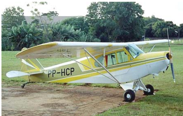
Figs 25a e 25b- Modelos com trem de pouso convencional (Paulistinha P-56) e com bequilha frontal (Cessna 150) (imagens do site www.aeroclube.com )
