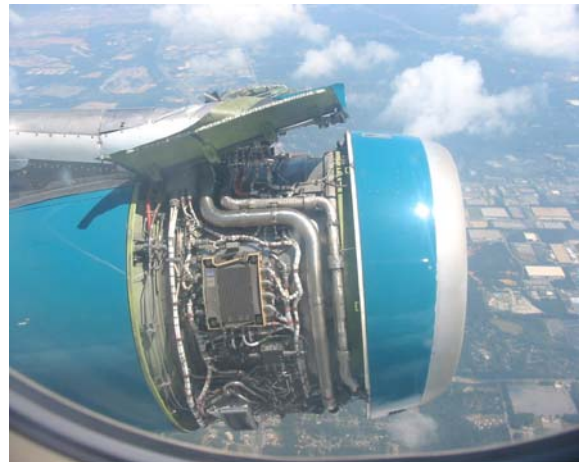
Fig.67a e 67b-Abertura não planejada de compartimentos das aeronaves. Potenciais focos de acidentes mortais (Fotos disponibilizadas pelo site America Aviation- www.americaviation.net )
