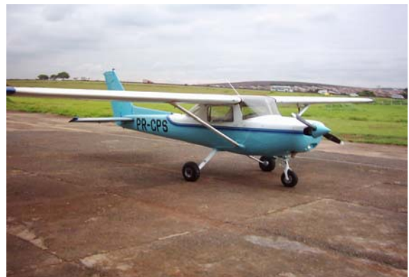
Figs 25a e 25b- Modelos com trem de pouso convencional (Paulistinha P-56) e com bequilha frontal (Cessna 150) (imagens do site www.aeroclube.com )
