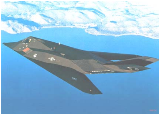
Figs.44a (disponibilizada pela América Aviation no site www.americaviation.net ) e 44b (foto do autor) Visões frontais limitadas do F-117 devido ao formato aerodinâmico e do antigo treinador básico civil Neiva Paulistinha P-56 quando em terra
