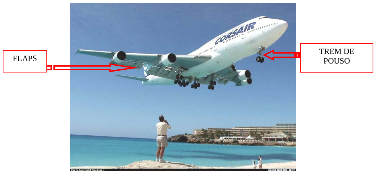
Fig.68- Hiper sustentadores estendidos e trem de pouso baixado ( Foto disponibilizada pelo site America Aviation- www.americaviation.net )
