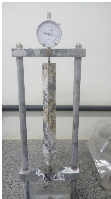
Fotografia 4 – Aferição da expansão das barras de argamassa
