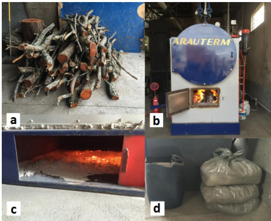
Fotografia 2 - Processo de queima da madeira de algaroba para obtenção das cinzas.
