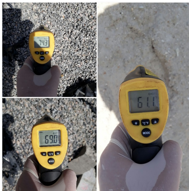
Fotografia 5 - Temperatura dos agregados aferida em condições externa de armazenamento.
