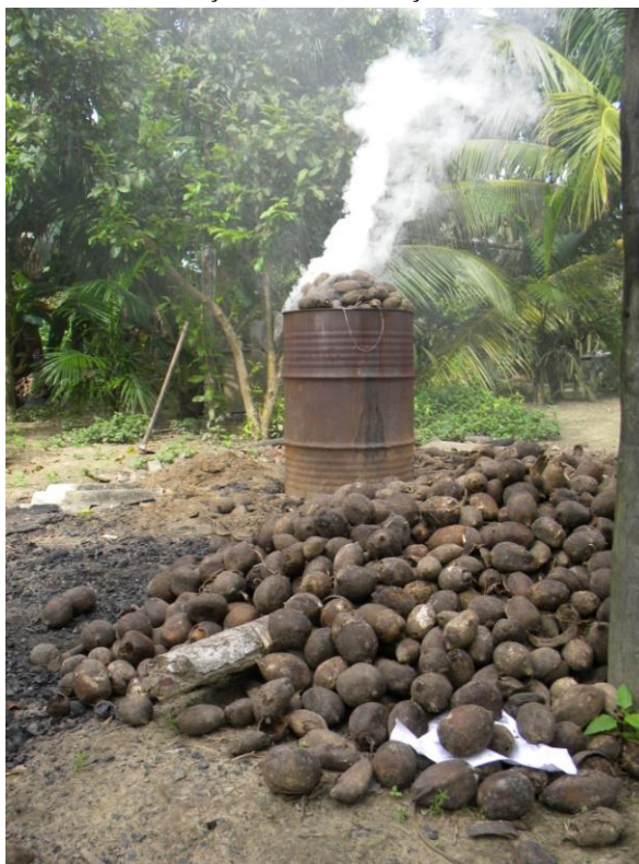
Fotografia 32 – Transformação do coco babaçu em carvão dentro do tambor
