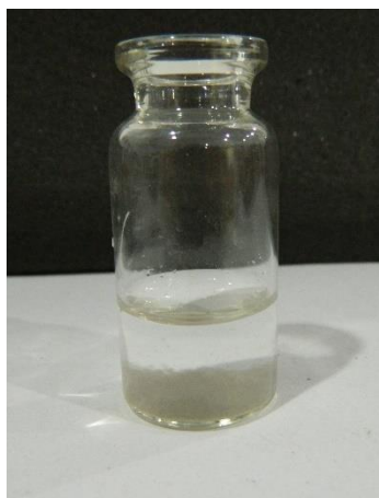
Figura 25 - Fotocorrosão seguida de desestabilização ocorrida na suspensão de ZnSe após 90 min de irradiação.
