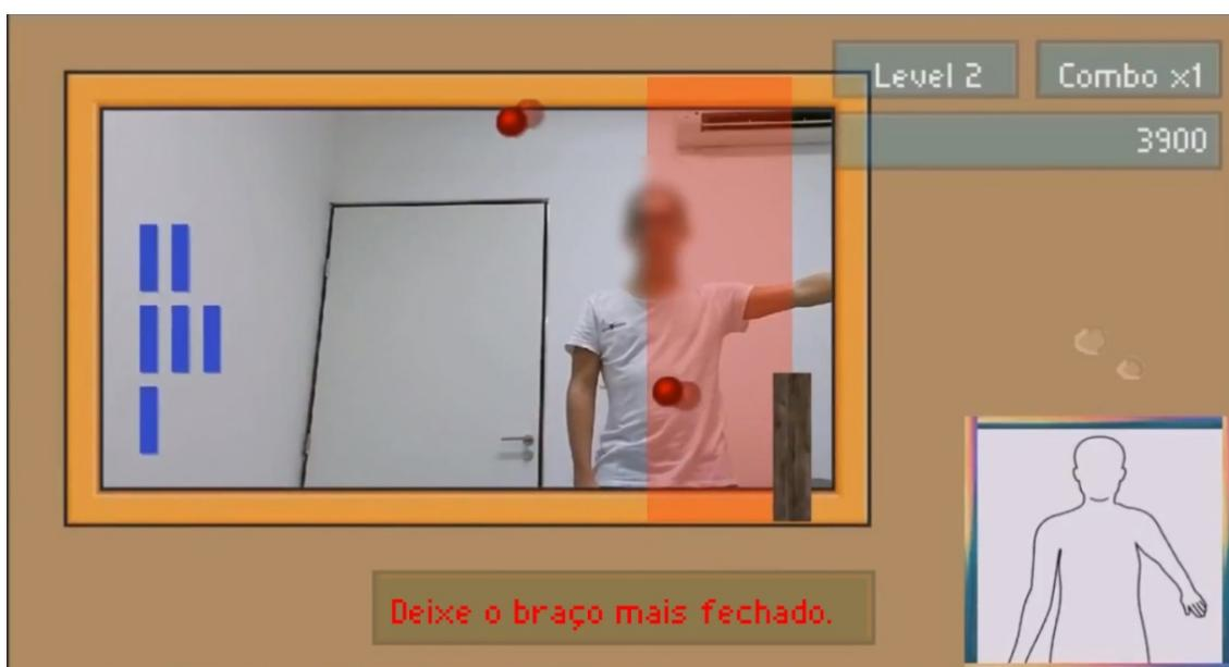
A barra móvel é controlada pelo movimento do braço, especificamente pelo ângulo de flexão / extensão do ombro. Os tijolos coloridos posicionados no lado oposto ao usuário precisam ser atingidos pelas bolas para marcar pontos. As bolas precisam acertar novamente a barra no caminho de volta, caso contrário, ficarão desabilitadas e não vão marcar quando baterem nos tijolos novamente (Figura 15).
