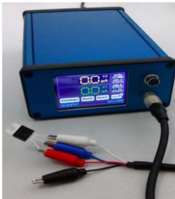
Figura 15: Sistema eletrônico utilizado para aquisição da leitura do sinal produzido pelo nanofilme.
