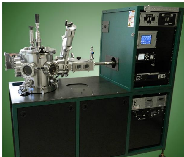
Figura 10: Equipamento modelo AJA ATC Orion 5UHV Sputtering System.
