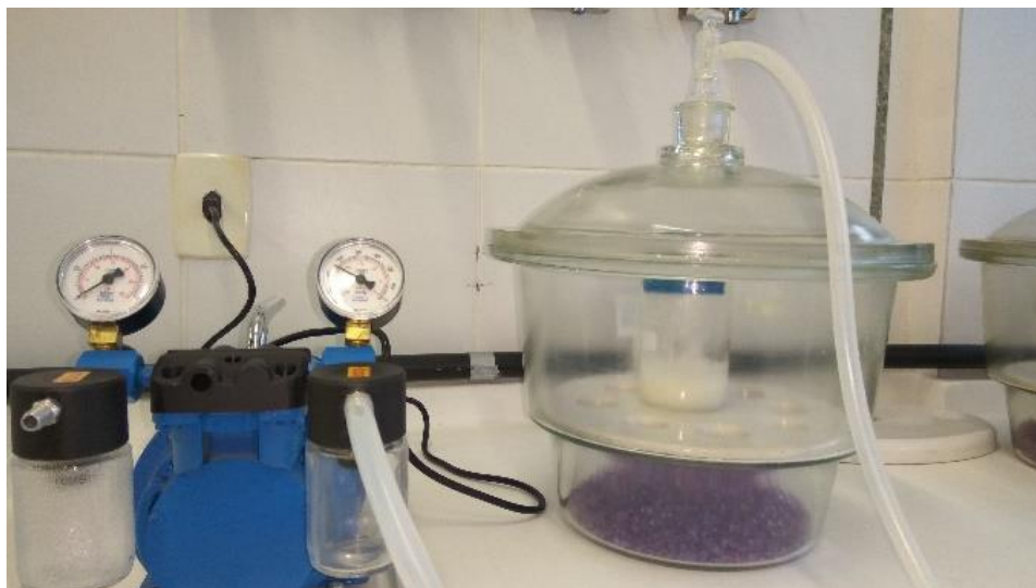
Figura 9 – Solução filmogênica em dessecador com bomba à vácuo
