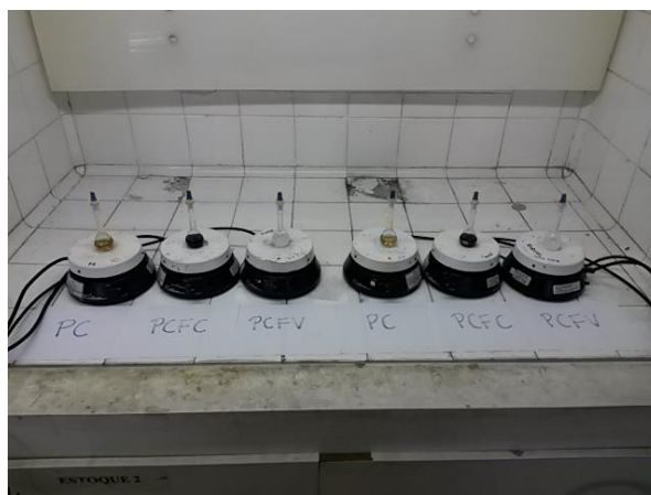
Figura 52 - Etapa de dissolução do PC, PCFC e PCFV para avaliação das propriedades viscosimétricas.
