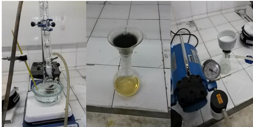
Figura 22 - Digestão ácida dos materiais compósitos.
