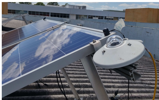
Figura 37 – Estrutura da montagem experimental. Módulo GBR 255p e Piranômetro CMP11 .
