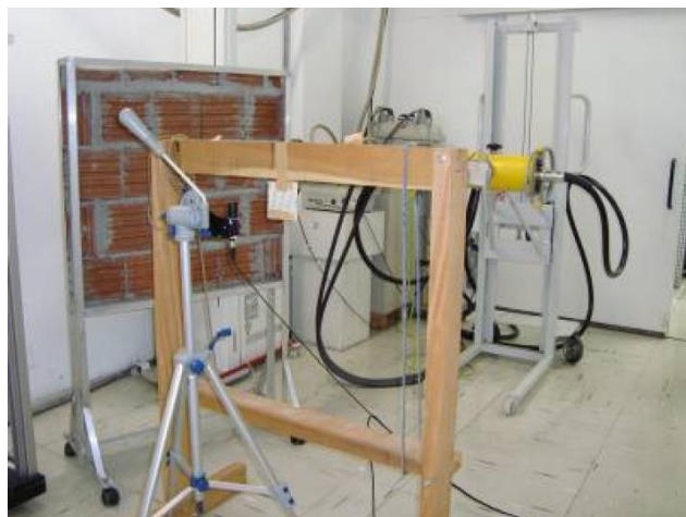
Figura 8– Arranjo experimental da equivalência em chumbo, utilizado para a determinação das propriedades de atenuação dos blocos cerâmicos.
