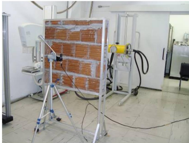
Figura 7 – Arranjo experimental utilizado para a determinação das propriedades de atenuação dos blocos cerâmicos.
