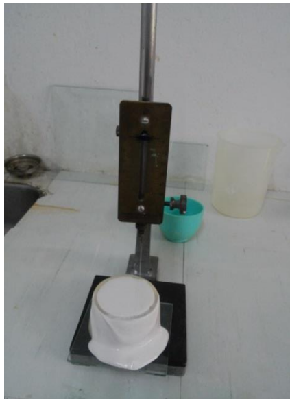
Figura 12 – Aparelho de Vicat modificado com agulha para medição do tempo de pega.
