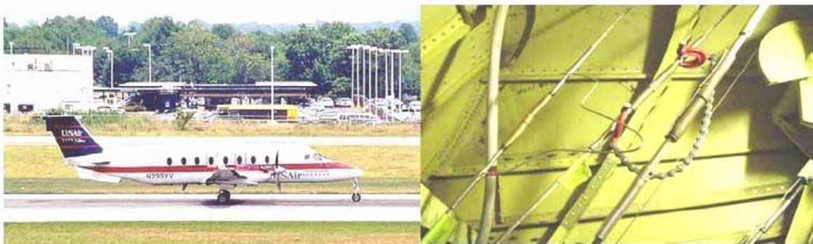
Figura 58 – O Beech 1900 envolvido no acidente. A direita, o cabo esticadores de ajustamento sobre os cabos de controle do elevador. Fonte: NTSB
