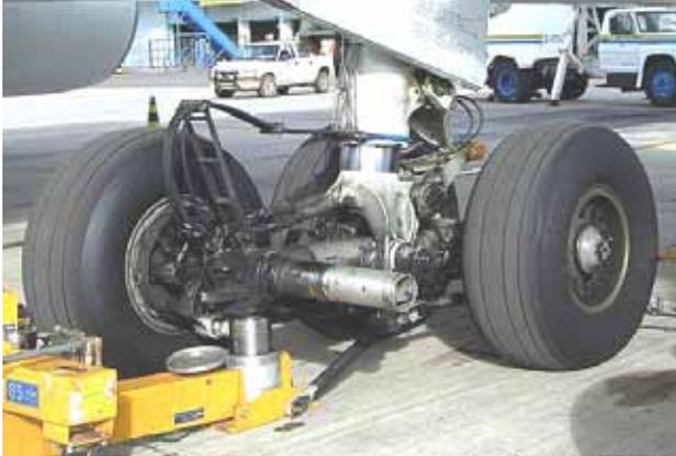
Figura 26 – A troca de uma roda de um Douglas DC-10 – Fonte: Autor – Acervo Pessoal
