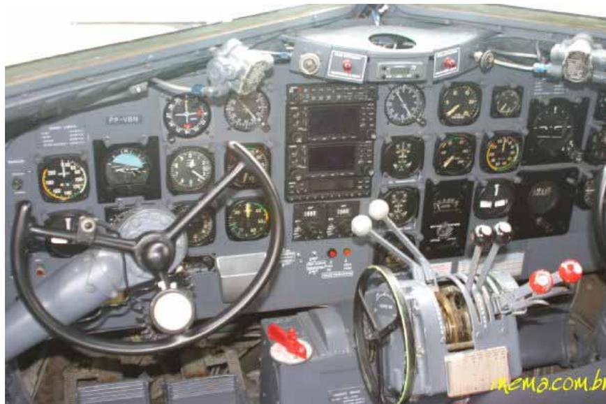
Figura 5 – Cockpit do Avião DC-3, com destaques para as manetes (Fonte: [www.inema.com.br](http://www.inema.com.br))
