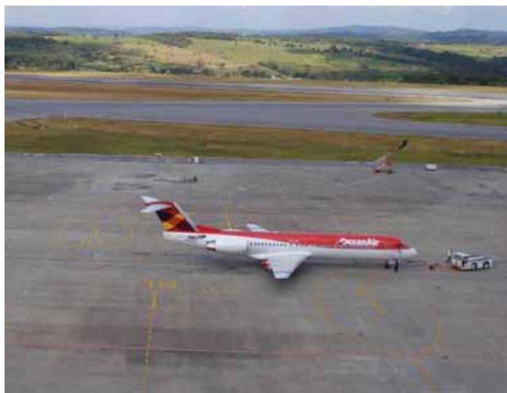
Figura 19 – Aeronave me procedimento de pushback (Fonte: do Autor)
