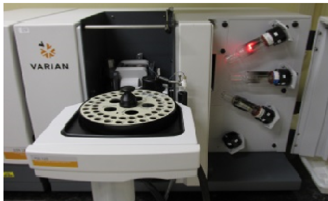
Figura 5 – Equipamento para análises químicas por GFAAS (acima) e ICP-MS (abaixo).
