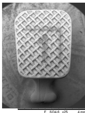
Figura 17 - Imagem em MEV da base dos braquetes Orthomundi.
