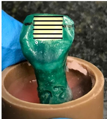
Figura 13 – Imagem representativa das 6 linhas de escaneamento do TCO com intervalos de 1 mm entre elas.
