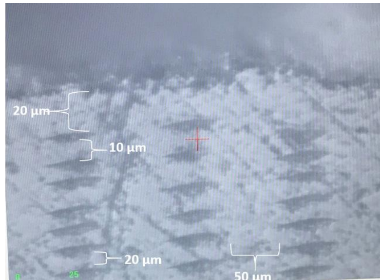
Figura 23 - Exemplificação das medidas feitas iniciando 20 \mu\text{m} abaixo da borda da lesão em corpo de prova representativo do G1.
