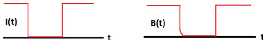
Figura 28 – Gráficos do decaimento da corrente e do campo magnético
