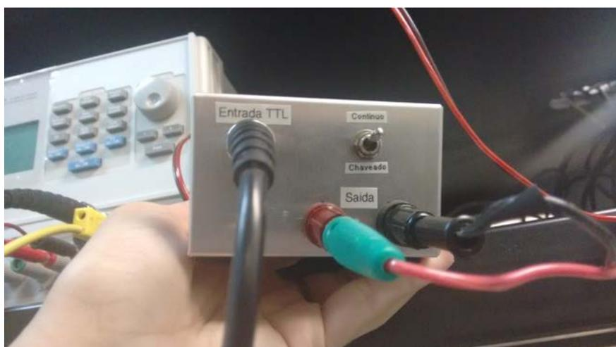
Figura 31 – Parte externa da caixa de chaveamento.
