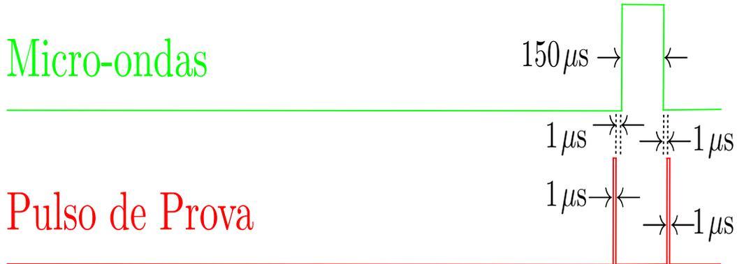
Figura 11 – Sequência temporal de pulsos utilizados para cancelar o campo.
