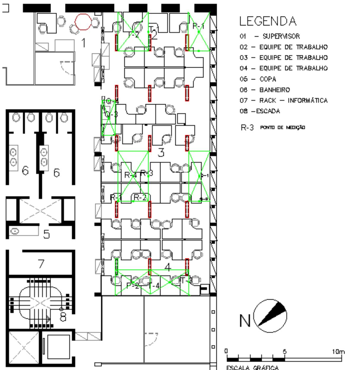
Figura 54 – Planta de medição de luminosidade
