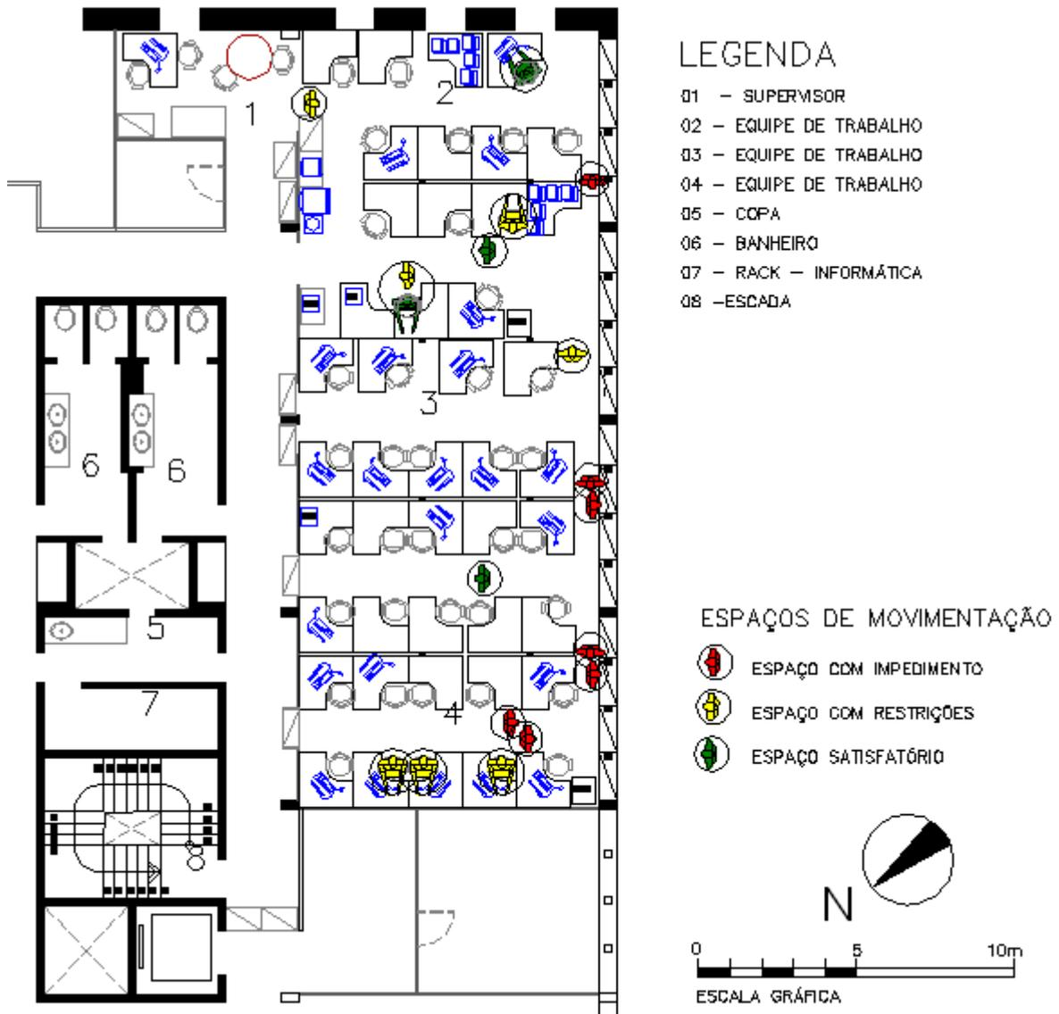
Figura 45 – Planta baixa dos espaços de movimentação
