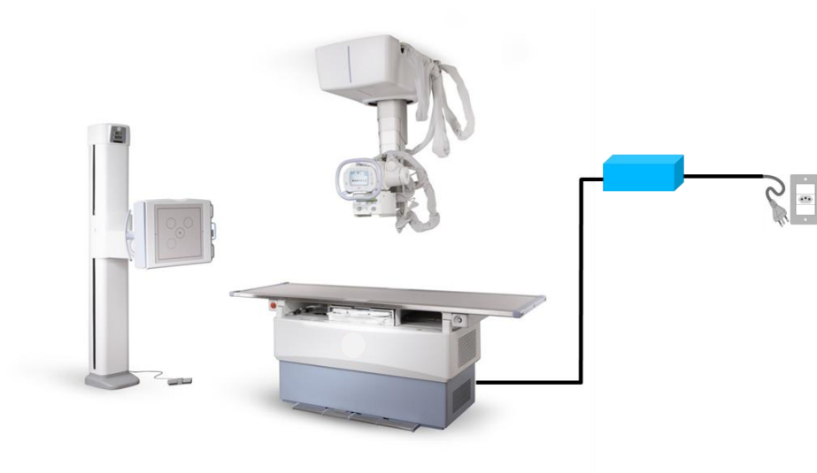
Figura 7 – Representação de como o módulo cliente é instalado em um EMH
