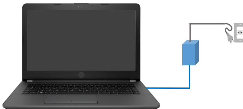
Figura 8 – Representação da ligação entre módulo PLC (caixa azul) e servidor, por meio de Ethernet, e do módulo sendo alimentado pela rede elétrica
