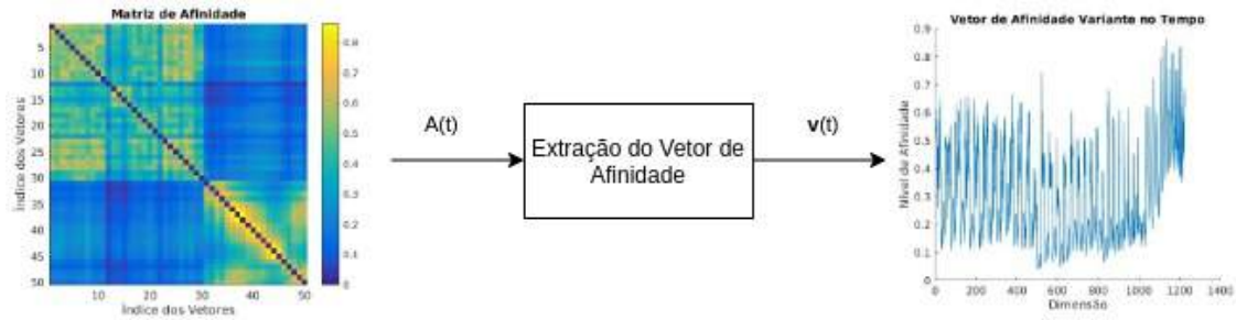
Figura 9 – Entrada e saída da etapa de extração do vetor de afinidade v(t) . A etapa engloba as operações de flattening da matriz de afinidade inferior, descartando os elementos da diagonal superior e da diagonal da matriz A(t) .
