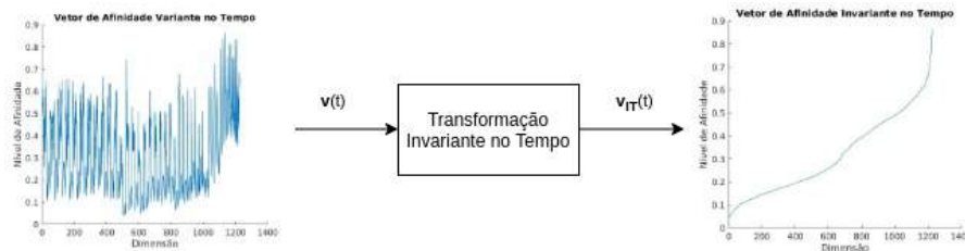
Figura 12 – Entrada e saída da etapa de cálculo do vetor de afinidade invariante no tempo \mathbf{v}_{IT}(t) .
