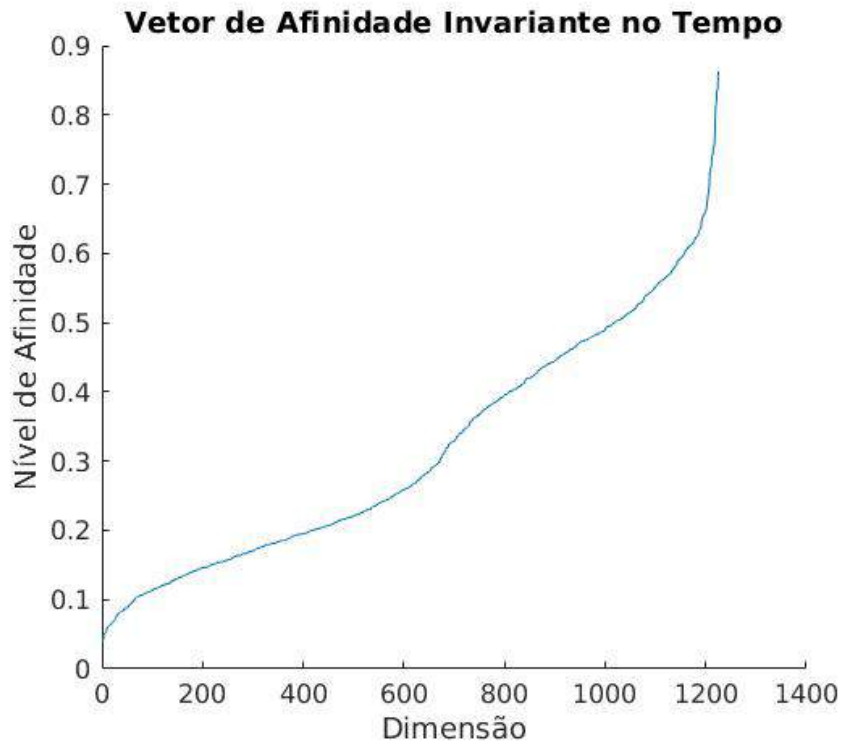
Figura 13 – Vetor de afinidade invariante no tempo \mathbf{v}_{IT}(t) obtido a partir do sorting dos componentes de \mathbf{v}(t) .
