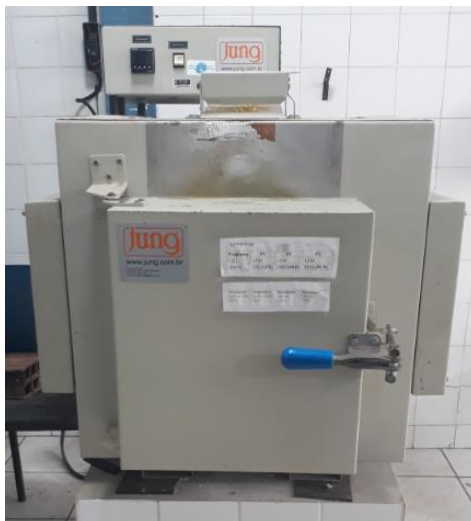
Figura 155 - Forno tipo mufla, modelo Jung 0614, temperatura máxima de 1400 °C.
