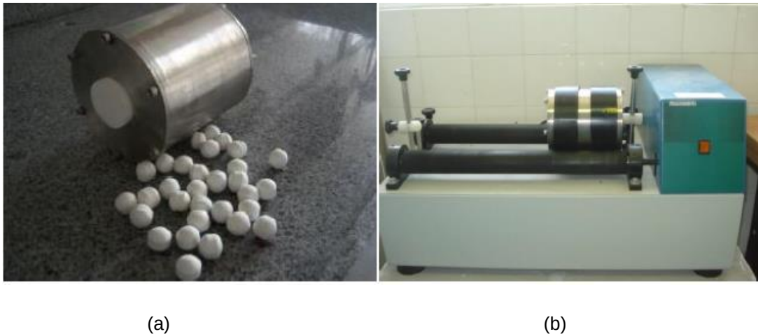
Figura 122 - (a) Jarra de aço inoxidável do moinho de bolas e bolas de alumina, e (b) Moinho de bolas.
