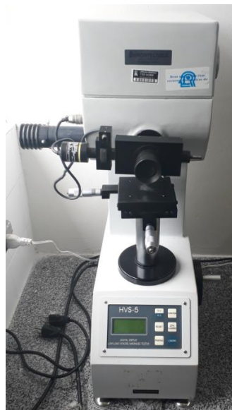
Figura 188 - Microdurômetro acoplado a um microscópio metalográfico Zeiss, modelo Jenavert com penetrador modelo HVS-5 nº 0021.
