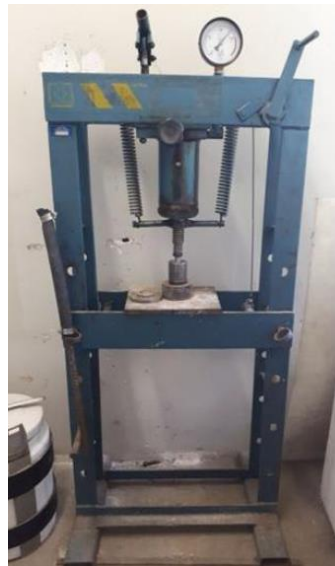
Figura 133 - Prensa hidráulica, marca SCHIWINING SIWA e modelo ART6500089.
