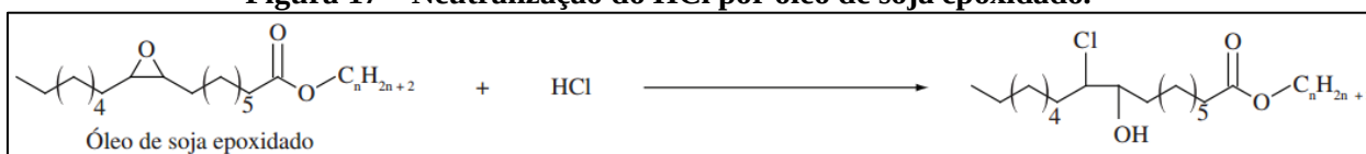
Figura 17 – Neutralização do HCl por óleo de soja epoxidado.
