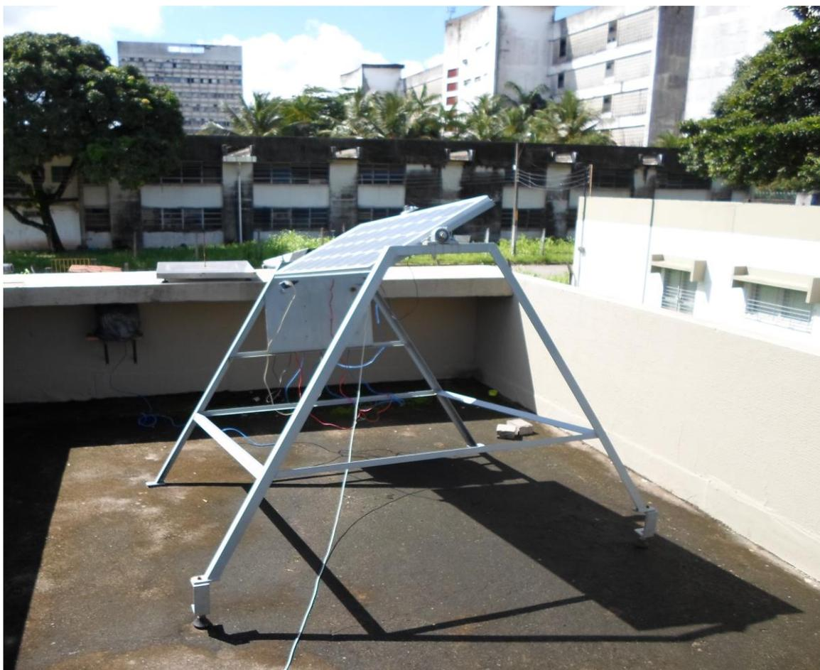
**Figura 14 – Visão do arranjo multi rastreador com a caixa de proteção do circuito**
