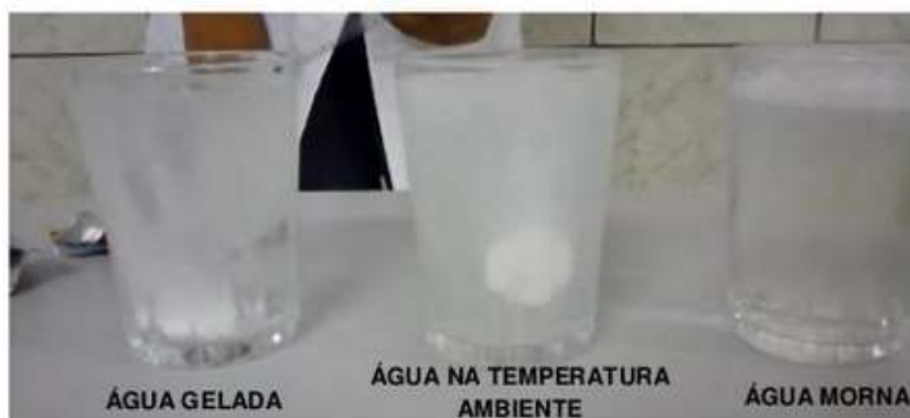
Figura 1: Influência da temperatura na velocidade de uma reação.
