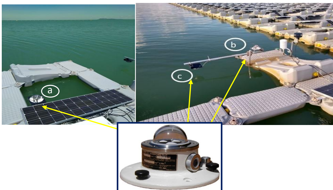
Figura 18 - Arranjo experimental Pato-II- Equipamentos e instrumentação (I)
