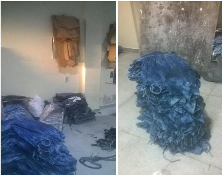
Figura 6: a primeira imagem são as peças ao final da produção que são empilhadas para a revisão; cada peça é verificada para identificar defeitos. Na imagem ao lado, as peças após passarem pela revisão.
