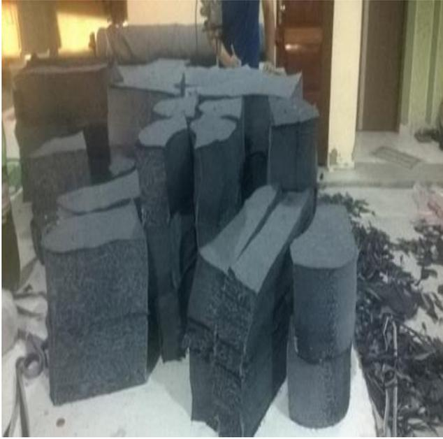
Figura 2: as peças após o corte. E ao lado no chão os retalhos do corte; os resíduos da produção.
