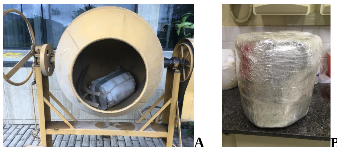
Figura 13 – Processo de homogeneização. A. Betoneira utilizada no processo de homogeneização. B. Recipiente de polietileno envolvido por espuma.
