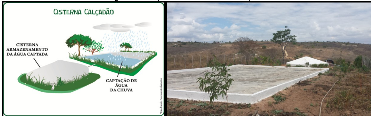
Figura 18 - Esquema de uma Cisterna Calçada
