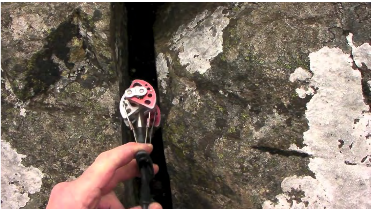
Equipamento de proteção móvel, que se expande, entalando nos espaços formados entre as rochas. Fonte: acervo pessoal.
