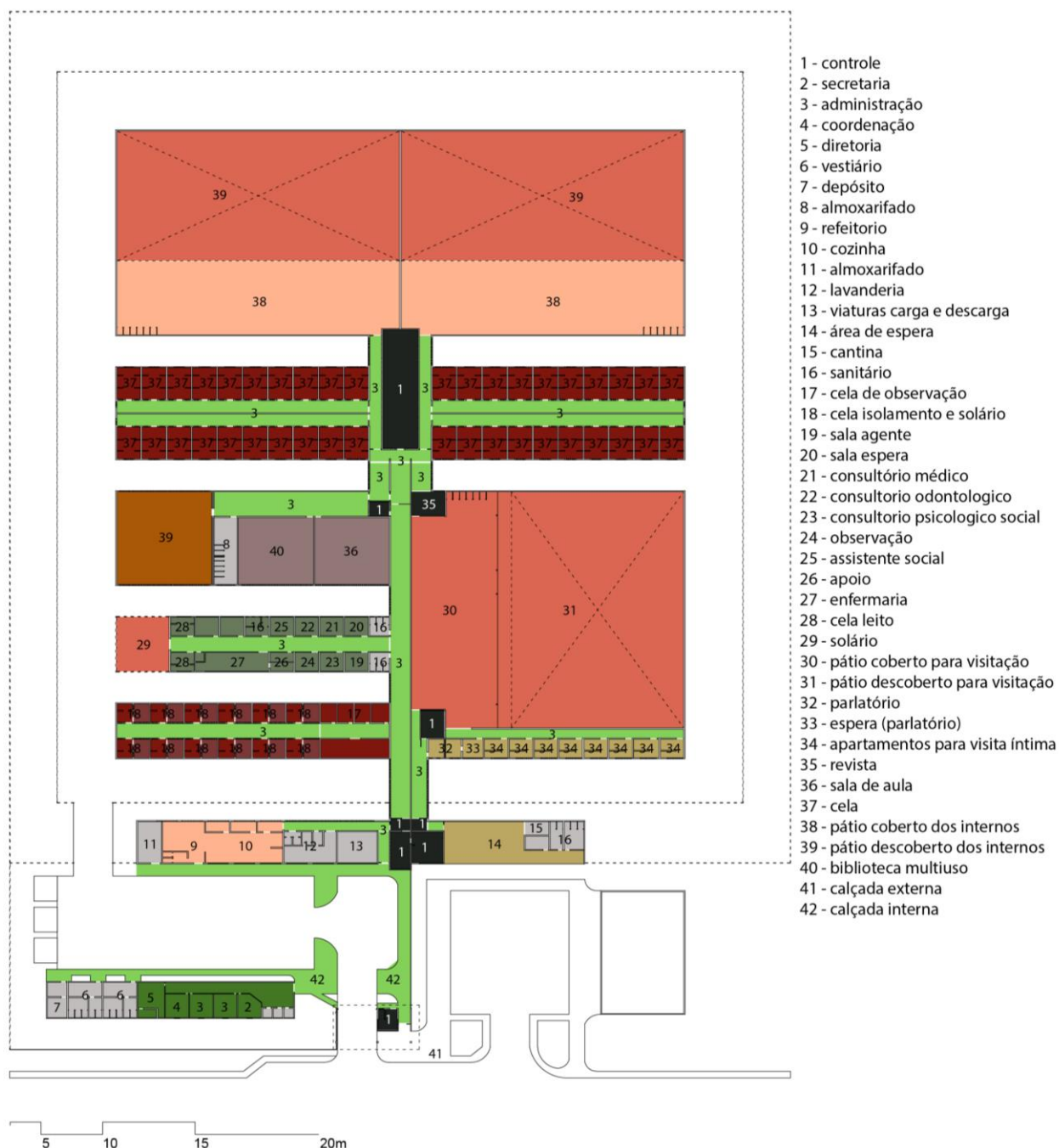
Figura 68 – Planta baixa: Unidade penal de modelo espinha de peixe e médio porte Fonte: CORDEIRO, 2017 (Adaptado).
