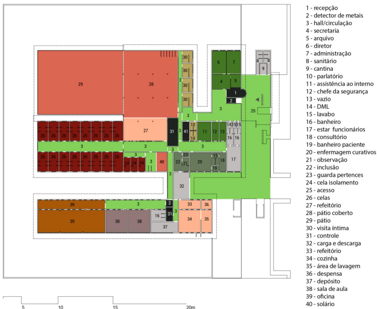
Figura 42 – Planta baixa: Unidade penal de modelo compacto e pequeno porte 20 Fonte: CORDEIRO, 2017 (Adaptado).
