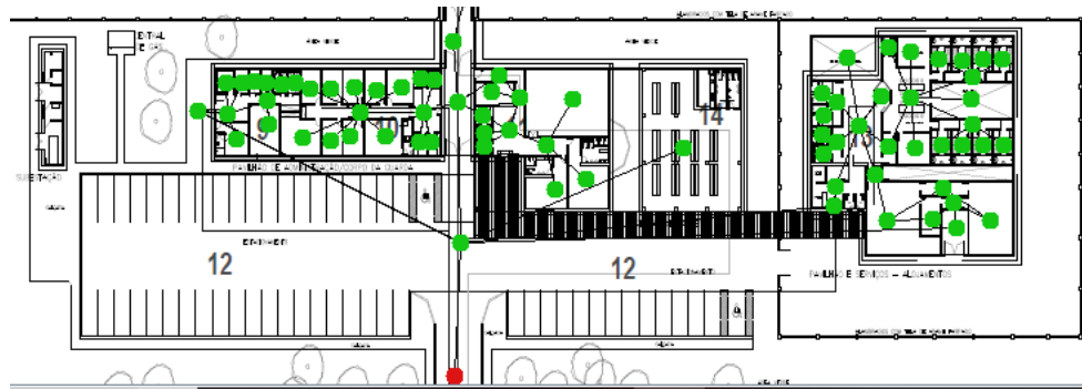
Figura 39 – Processo de elaboração do grafo justificado no JASS. O ponto vermelho é a raiz do sistema. Os pontos verdes são os diversos espaços convexos do plano espacial
