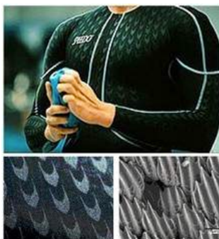
Figura 4 – Fastskin : Tecido tecnológico inspirado na pele de tubarão que aumenta capacidade de nadar
