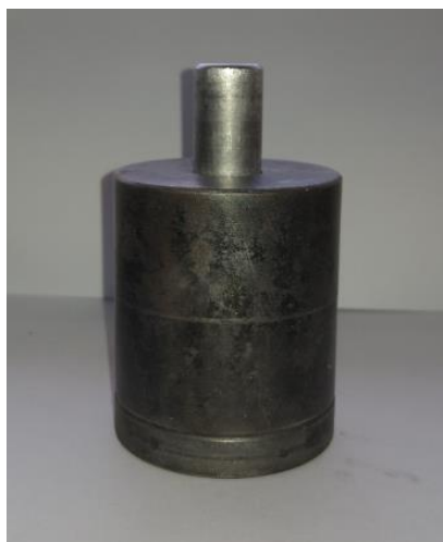
Figura 17 - Matriz metálica de aço VC131
