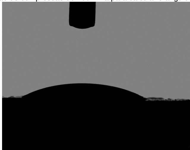
Figura 34 - Fotografia do gotejamento na superfície do comprimido contendo 50% de PSA e MCC sob pressão de compressão de 250 MPa para calcular o ângulo de contato.
