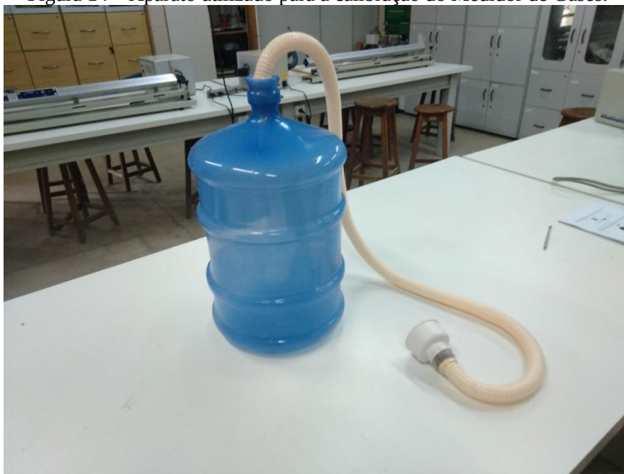
Figura 14 – Aparato utilizado para a calibração do Medidor de Gases.
