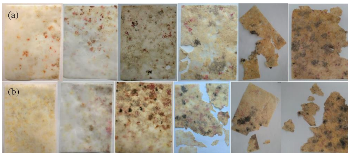
Figura 15 - Aspecto macroscópico dos filmes de (a) 2% Óleo Essencial de Canela/PBAT e (b) PBAT puro após período de biodegradação. Da esquerda para a direita, os tempos de biodegradação são de: 4, 8, 12, 16, 20 e 24 semanas.
