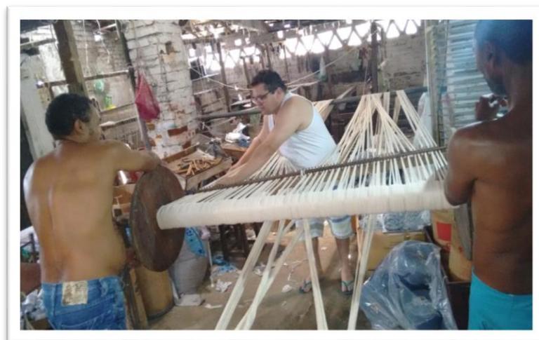
Figura 7 - Transferência dos fios da urdideira para o rolo do tear.
