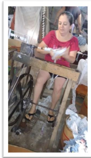
Figura 11 - Processo de enchimento da espula na caneleira.
