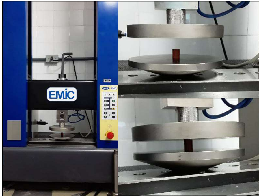
Figura 14 - Corpo de prova em prensa universal para teste de resistência à compressão
