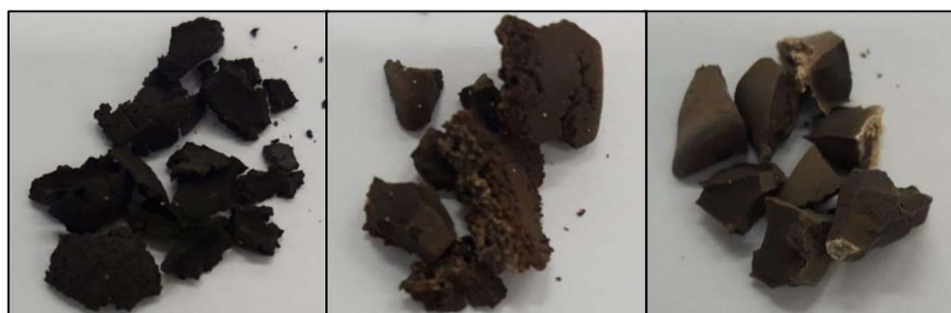
Figura 26 - (a) Lodo seco em estufa a 105 °C. (b) Lodo com adição de MgO em relação ao teor de Alumínio seco em estufa a 105 °C. (c) Lodo com adição de MgO com relação ao teor de Alumínio + Ferro seco em estufa a 105 °C
