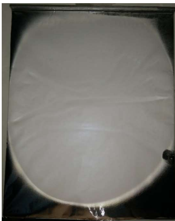
Figura 23 – Membrana de PS (branco) depositada sobre papel alumínio após o processo de eletrofição
