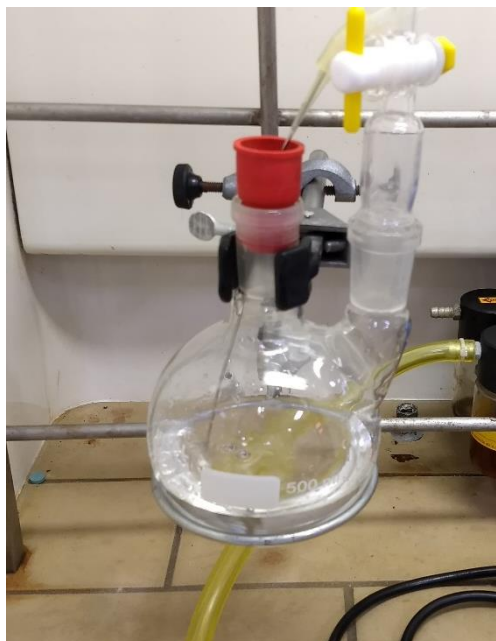
Figura 26 - Preparação da solução de íons S^{2-}/SO_3^{2-} utilizada nos testes de produção de H_2 .
