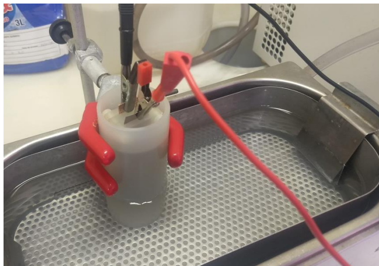
Figura 16 - Célula eletroquímica para anodização das folhas de Ti.
