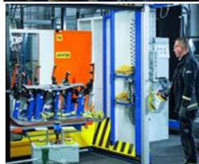
O robô realiza a soldagem e transporta a peça para próxima operação onde outro operador adicionará outros componentes.
