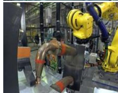
Os gestos realizados durante a execução das atividades nas operações de montagem são similares, variando no transporte da carga de acordo com o componente manuseado que se diferenciam no peso e na geometria do componente. Além do processo de montagem, há o processo de inspeção da qualidade, utilizando o torquimetro para checagem de parafusos, espátula para retirada de respingo de solda e colocação da peça na embalagem final, semelhante a figura 11.
