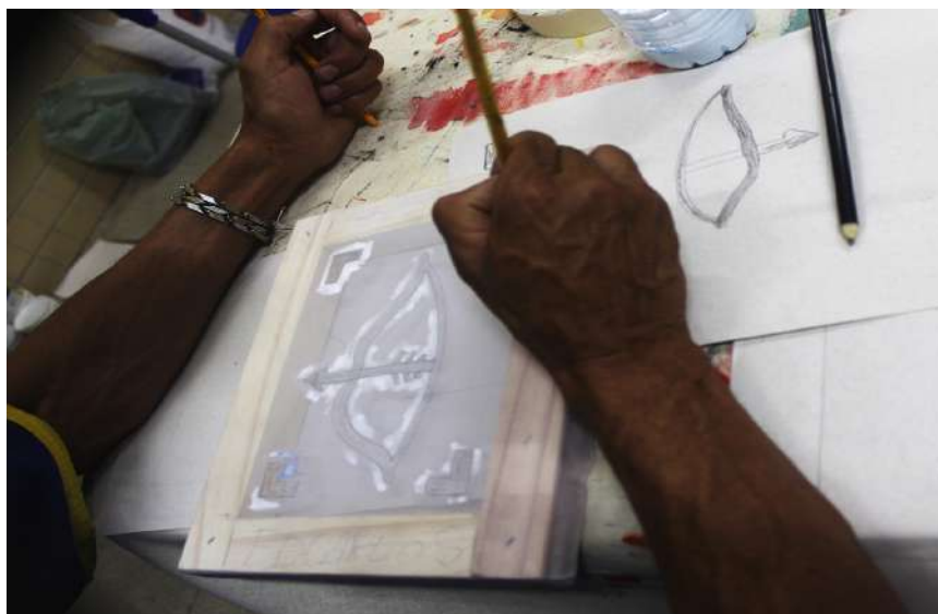
Figura 29 - Processo do registro do desenho e aplicação da cola na tela de serigrafia
