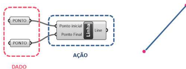
Figura 64 - Funcionamento básico dos comandos da modelagem paramétrica no plug-in Grasshopper .
