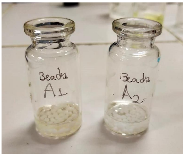
Figura 31 - Beads formados a partir dos líquidos iônicos A1 e A2 a 25%.
