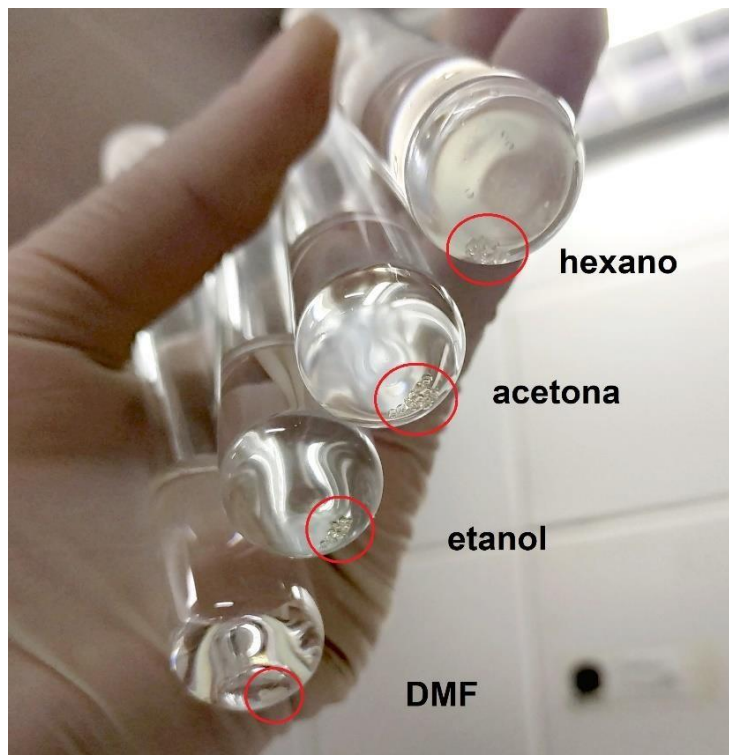
Figura 35 - Beads/A1 na presença dos solventes etanol, acetona, DMF e hexano.
