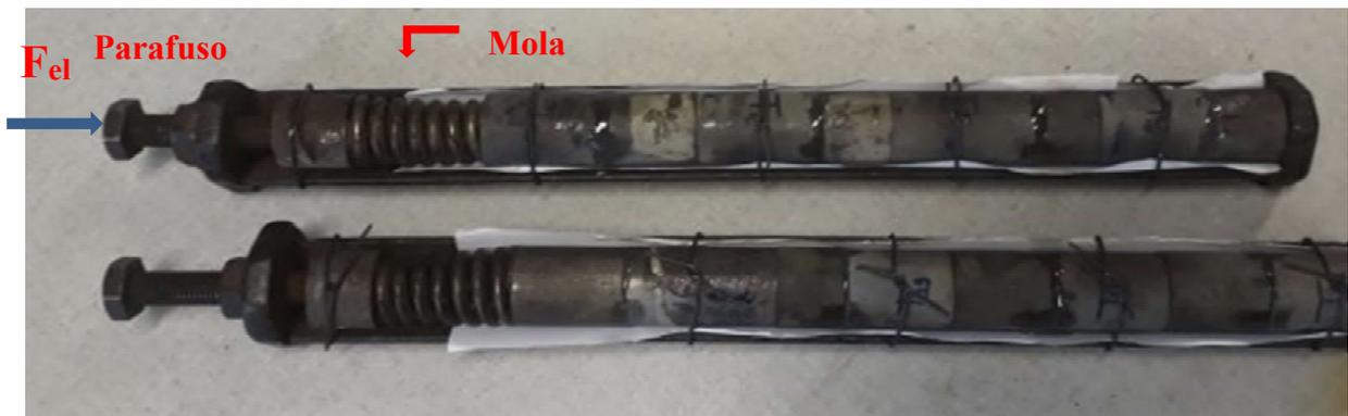
b) Amostras acomodadas no dispositivo de colagem durante o tempo de cura do adesivo
