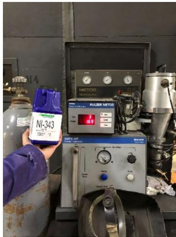
(b) Equipamento com a super liga de níquel Ni-343
