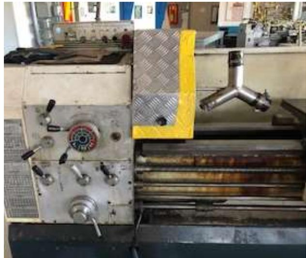
(b) Misturador em Y usado para homogeneizar os compósitos cerâmicos
