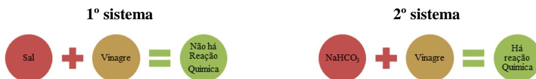
**Figura 8: Esquema do 1º Experimento - Reações Químicas.**
